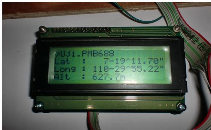
Gambar 4. Tampilan hasil terjemahan data modul PMB688
